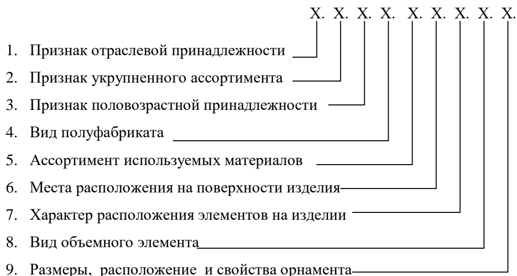
Рисунок 5 – Структурная схема классификатора изделий с объемными декоративными элементами
