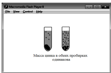
Рис.4. Зависимость скорости химической реакции от поверхности соприкосновения реагирующих веществ.
