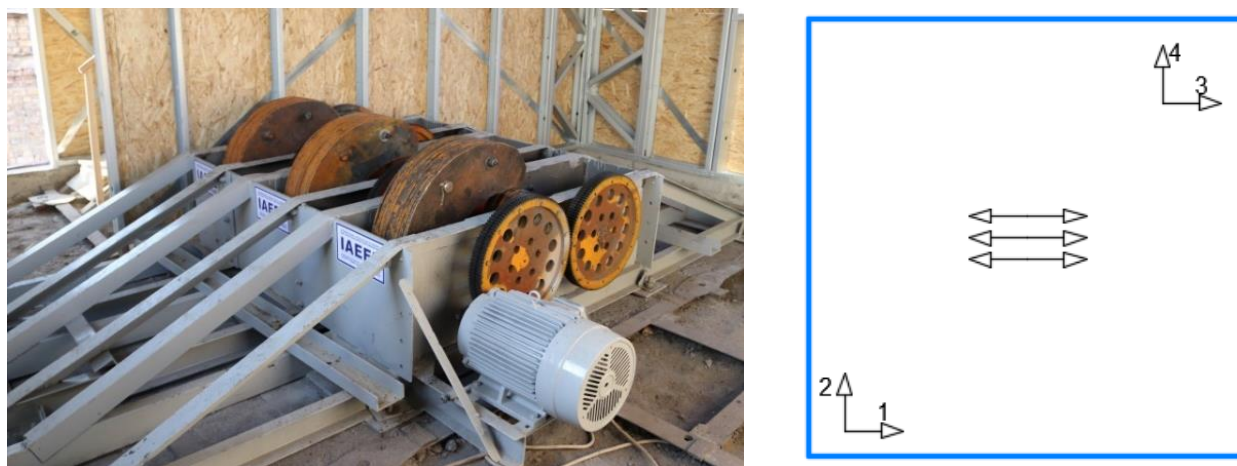
Рисунок 2 – Общий вид мобильной вибромашины и схема расстановки акселерометров на платформе
