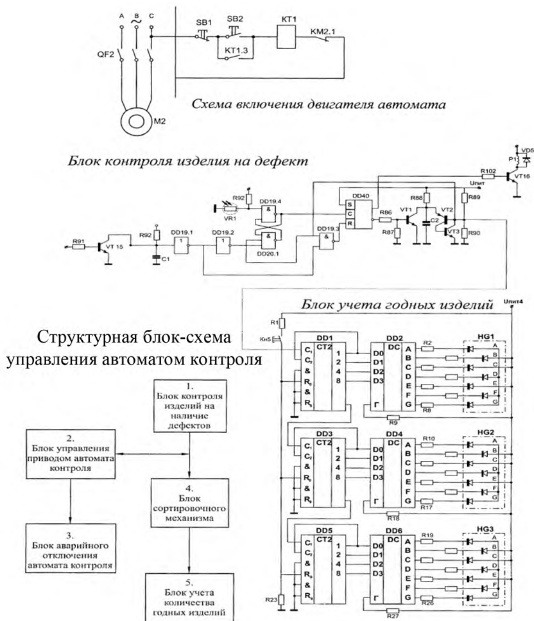
Рис. 21. Принципиальная схема контроля наличия рельефных дефектов на изделиях типа тел вращения
