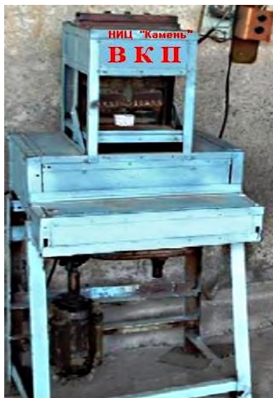
Рисунок 12 - Опытный образец малого винтового камнекольного пресса ВКП-50
