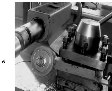
Рис. 3 - Оправка для ротационной обработки (а) и многолезвийные ротационные режущие инструменты из быстрорежущей стали Р6М5(б), установленная оправка в резцедержатель токарного станка (в), однолезвийный ротационный резец (г)
