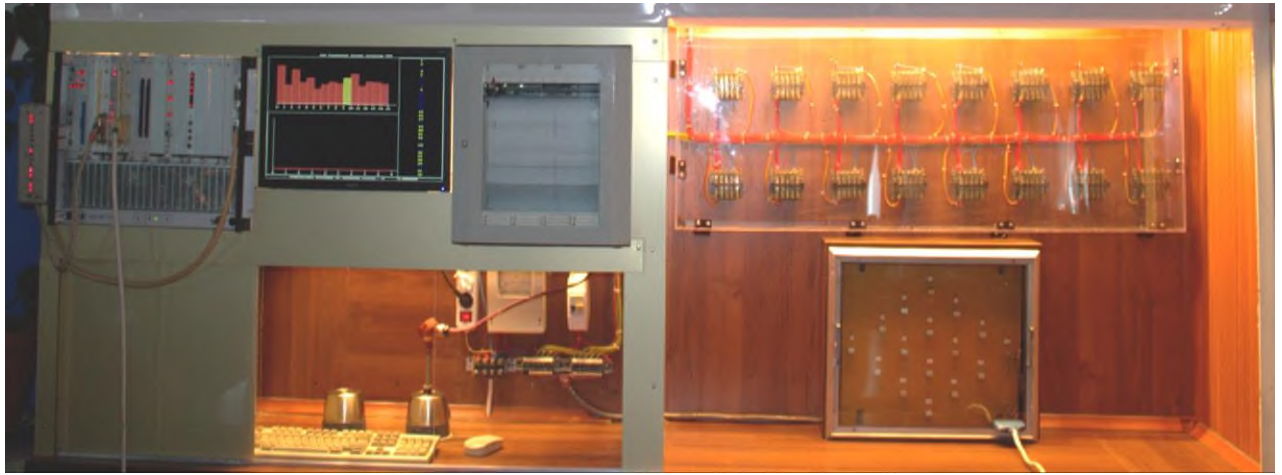
Рис. 5. Экспериментальная установка с элементами АСНИ для мониторинга и диагностики элементов электрических сетей
