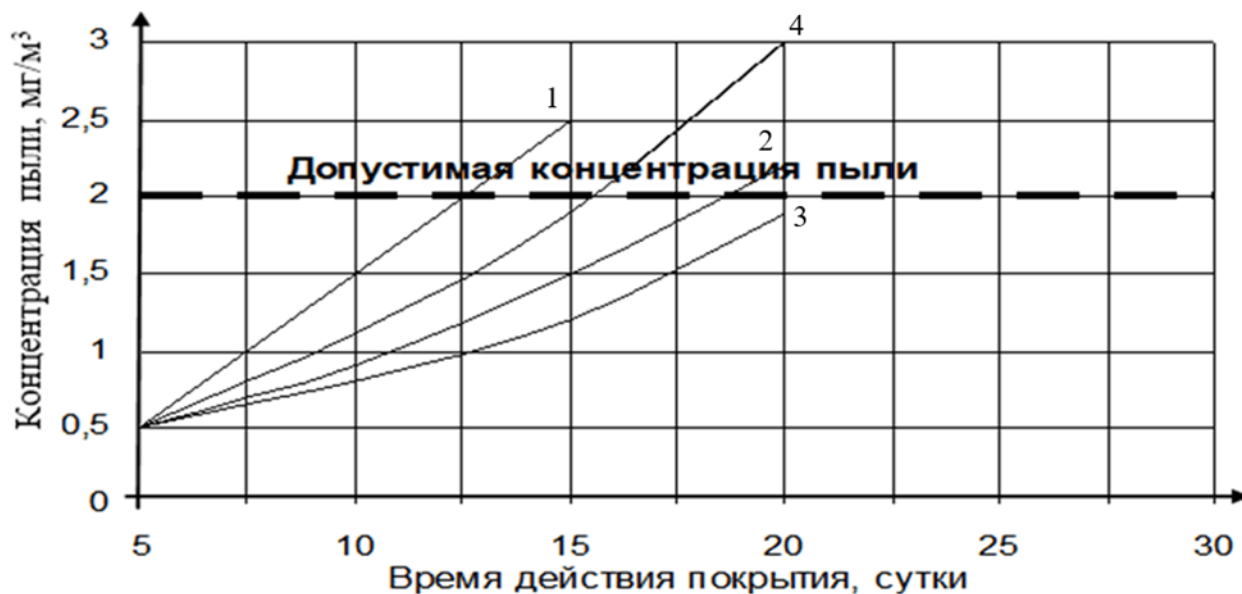
Рисунок 12 - Эффективность обеспыливания поливом автодорог (по данным автора) [12]:
