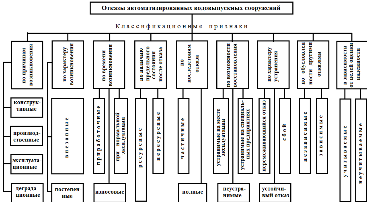
Рис.1. Классификация отказов автоматизированных водовыпускных сооружений.
