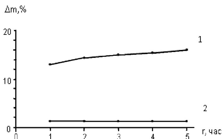
Рис.9. Кинетические кривые окисления ультрадисперсного карбида титана, синтезированного в условиях искрового разряда, при температурах  $500^0\text{C}$  (2) и  $900^0\text{C}$  (1)
