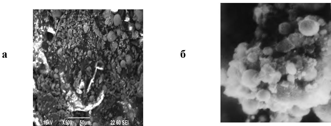
Рис.3. Микрофотографии частиц карбида титана, синтезированного при электроискровом диспергировании титана в гексане (а) и сплава ТН20 в этиловом спирте (б).
