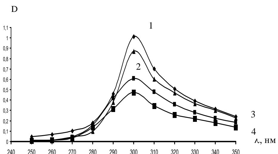
Рис.10. Спектры поглощения супензии УД карбида вольфрама, синтезированного в условиях искрового разряда, в воде (1), в растворах глицерина (2) и желатины (3) в воде, и в этиловом спирте (4).
