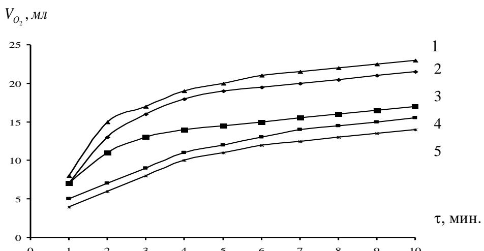
Рис.14. Кинетические кривые реакции разложения пероксида водорода в присутствии УД карбида титана в различных средах при  $70^{\circ}\text{C}$ . Среда: 1-1н  $\text{HCl}$ ; 2-1н  $\text{HNO}_3$ ; 3-  $\text{H}_2\text{O}$ ; 4-1н  $\text{H}_2\text{SO}_4$ ; 5-1н  $\text{NaOH}$ .
