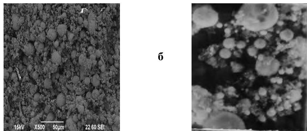
Рис.2.Микрофотографии частиц карбидов вольфрама, синтезированных при электроискровом диспергировании вольфрама в гексане (а) и сплава ВК8 в четыреххлористом углероде (б).
