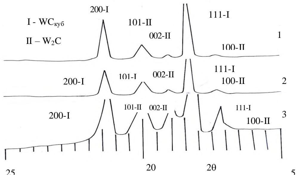
Рис.1. Дифрактограммы продуктов электроискрового диспергирования вольфрама в гексане (1), 5%-растворе стирола в гексане (2) и сплава ВН8 в этиловом спирте (3).
