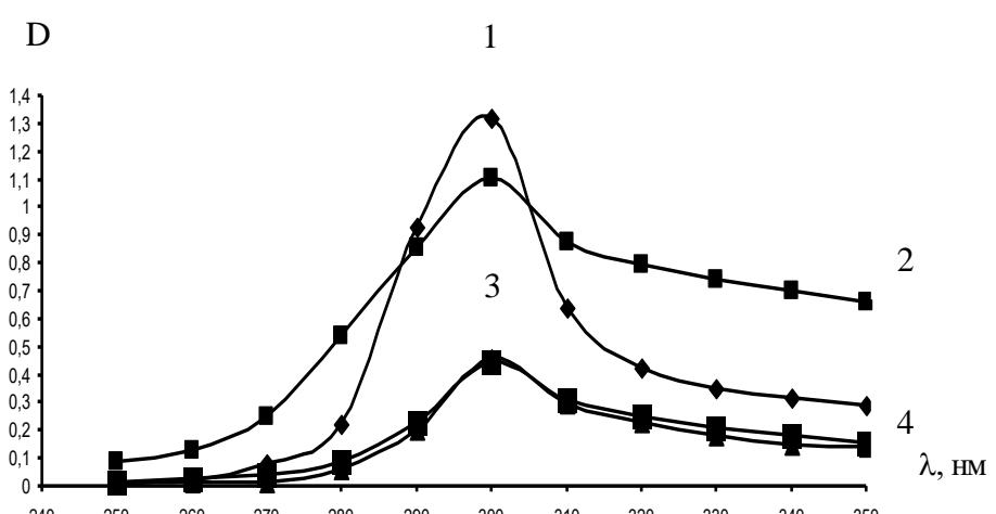
Рис.11. Спектры поглощения суспензии УД карбида титана, синтезированного в условиях искрового разряда, в воде (1), в этиловом спирте (2), в растворах желатины (3) и глицерина (4) в воде.
