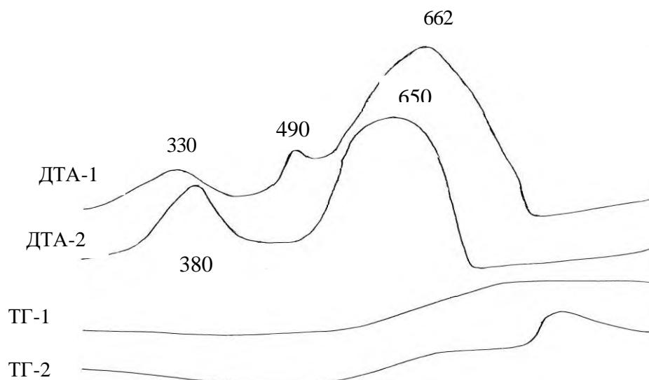
Рис.6.Кривые ДТА и ТГ дериватограммы карбидных продуктов, полученных при электроискровом диспергировании вольфрама в гексане (1) и в 5%- растворе стирола в гексане (2).
