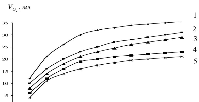
Рис.13. Кинетические кривые реакции разложения пероксида водорода в присутствии УД карбидов вольфрама в различных средах при  $70^{\circ}\text{C}$ . Среда: 1-1н  $\text{HNO}_3$ ; 2-1н  $\text{H}_2\text{SO}_4$ ; 3-1н  $\text{HCl}$ ; 4-  $\text{H}_2\text{O}$ ; 5-1н  $\text{NaOH}$ .
