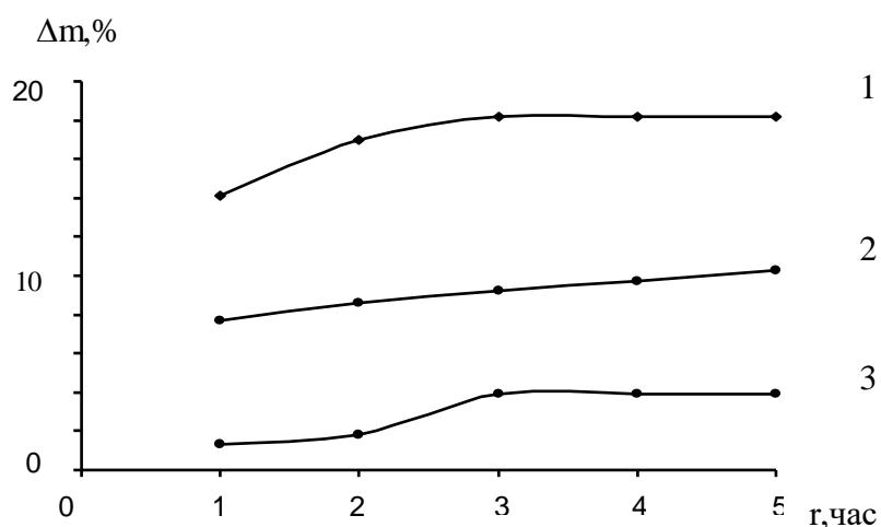
Рис.8. Кинетические кривые окисления ультрадисперсных карбидов вольфрама, синтезированных в условиях искрового разряда, при температурах  $300^{\circ}\text{C}$  (3),  $500^{\circ}\text{C}$  (2) и  $900^{\circ}\text{C}$  (1).
