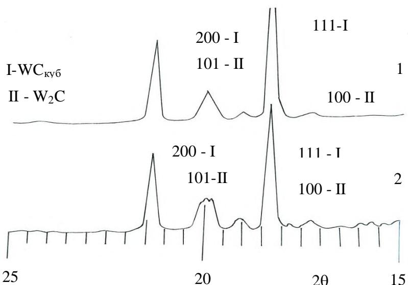
Рис.7. Дифрактограммы карбидов вольфрама до (1) и после (2) термообработки при  $350^{\circ}\text{C}$ .
