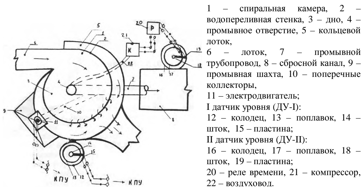
Рис.16. Моделирование автоматизированной защиты наносорегулирующего сооружения от завалами наноса (по патенту РФ №2109104).
