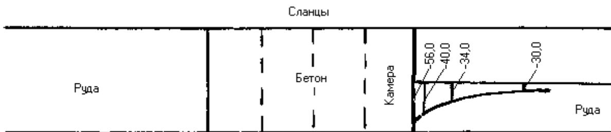
Рис. 11. Распределение напряжений на контакте руда-сланцы
