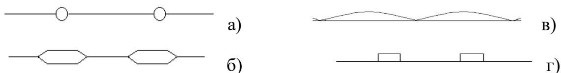
Рис. 1.1. Конструктивные схемы тепловоспринимающих поверхностей низкопотенциального солнечного коллектора
