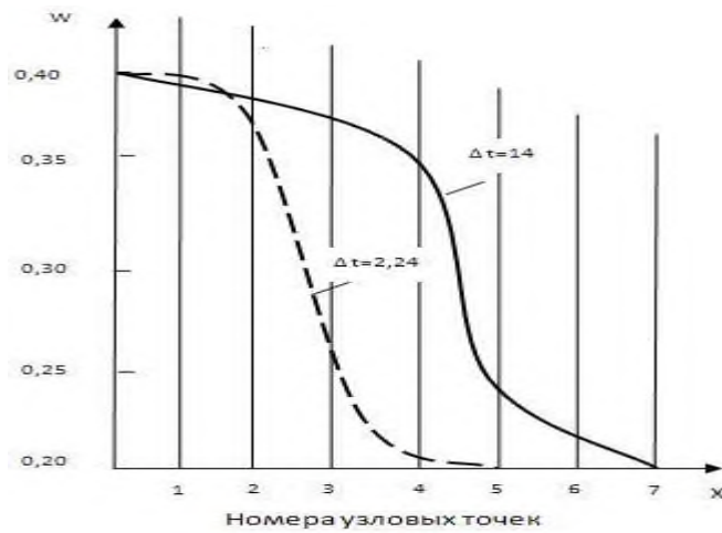
Рис.8. Распределение влажности вдоль колонки грунта при различных значениях \Delta t : 1ч. и 2,4 ч.
