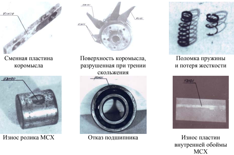
Рис. 5 – Типичные отказы импульсных вариаторов типа «ИВА»
