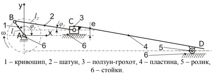
Рисунок 4 – Схема сортировочного механизма грохота с кривошипно-ползунным механизмом
