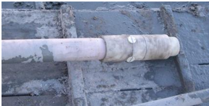
5-сүрөт – Технологиялык скважиналардын чыпкалоочу мамысынын учунун кайырмасын тыгындоо үчүн түзүлүш
