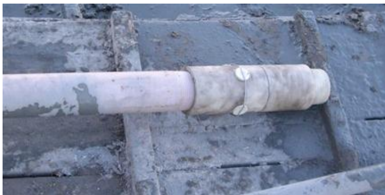
Рисунок 5 – Устройство для манжетного тампонирования фильтровой колонны технологических скважин
