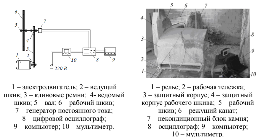
Рисунок 31 – Схема экспериментального стенда
