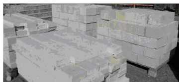
Рисунок 37 – Строительные изделия, полученные машиной КМЦ-1
