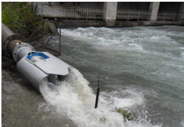
Рис. 16. МикроГЭС с бироторным гидрогенератором во время эксперимента.
