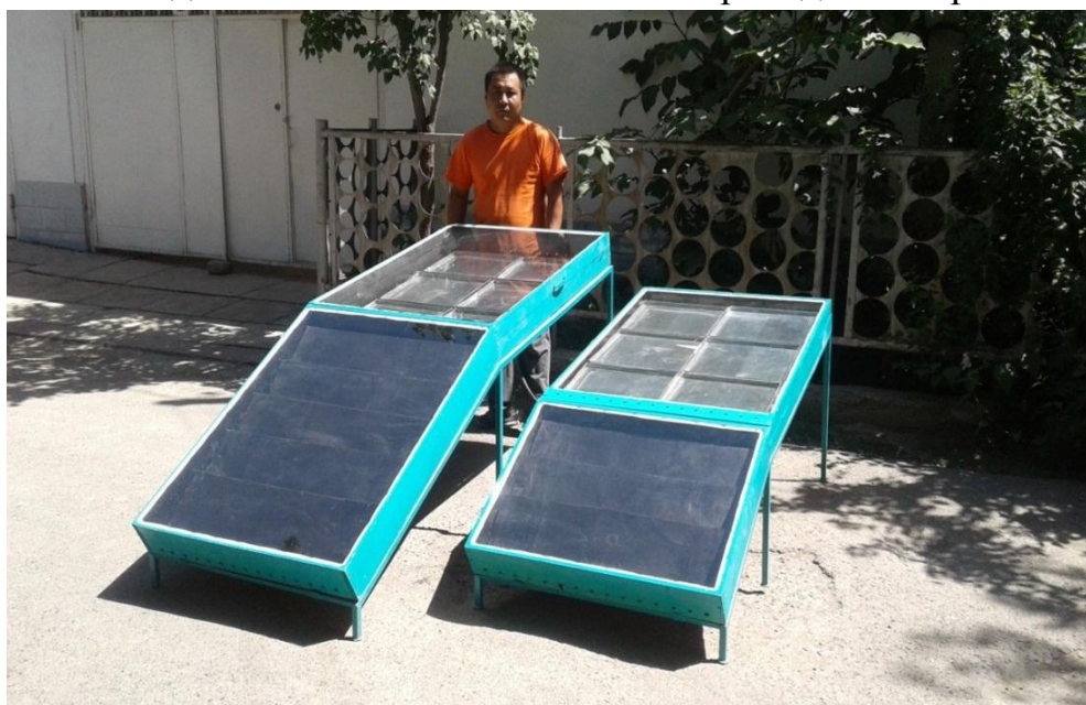
Рис. 4. Внешние виды ССУ с одноходовым (слева) и двухходовым движением теплоносителя
