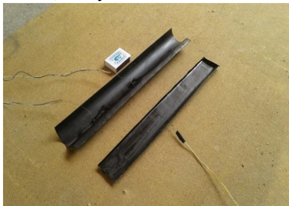
Рис. 8. КНЭ с прикрепленными к ним термопарами
