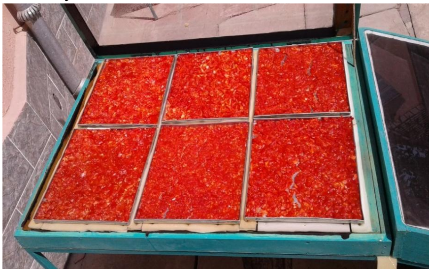
Рис. 10. Размещение поддонов с продуктами (томаты) в камере сушки РКССУ с двухходовым движением теплоносителя
