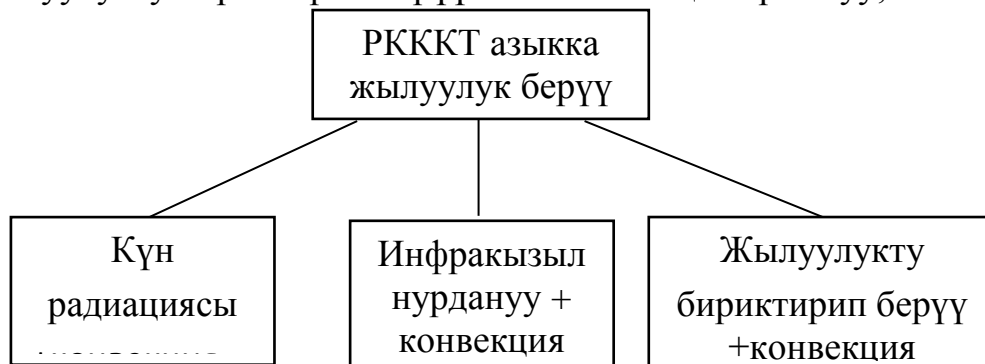
2-сүрөт. Радиациялык-конвективдүү түрдөгү күндө кургатуучу түзүлүштө кургап жаткан азыкка жылуулук берүү схемасы
