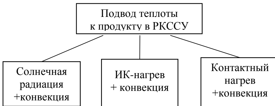
Рис. 2. Схема подвода теплоты к высушиваемым продуктам в радиационно-конвективной солнечной сушильной установке
