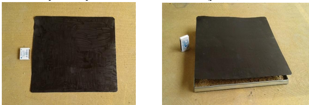
Рис.6. Внешние виды инфракрасных нагревательных элементов КНЭ изготовлены и испытаны нами двух геометрических форм: цилиндрической и плоской (рис. 7).
