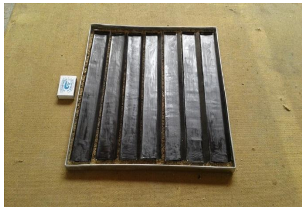
Рис. 9. Расположение плоских КНЭ на высушиваемых жидковязких продуктах
