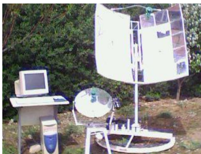
Рис.12. Концентратор солнечного излучения для адаптации и обеспечения наперед заданными параметрами температуры
