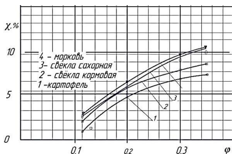
Рис.8. График повреждаемости поверхности корнеклубнеплодов от коэффициента заполнения шнека \varphi_{ш} при D_{ш} = 0,35 м и частоте вращения шнека n_{ш} = 735 \text{ мин}^{-1} .
