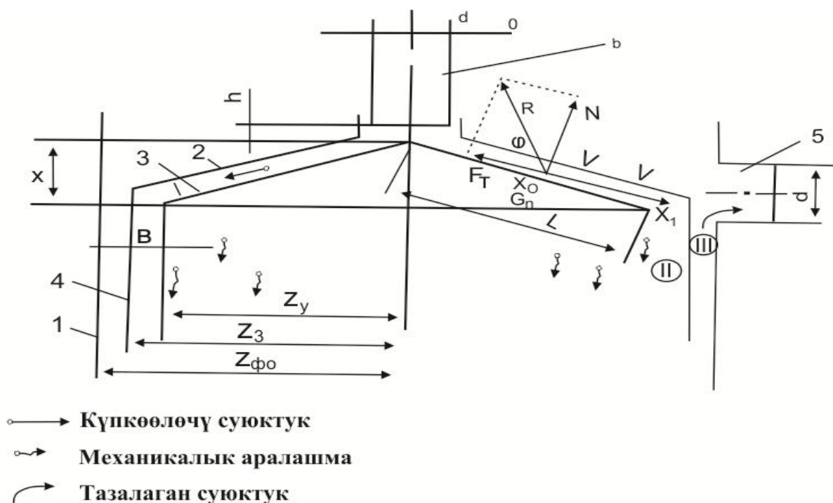
5-сүрөт. Чыпка-тундургучтун эсептик схемасы: 1-чыпка-тундургуч; 2-кабыл алгыч; 3-конустуу тынчтандыргыч; 4-чыпка; 5-төгүүчү түтүк; 6-соруучу түтүк.
