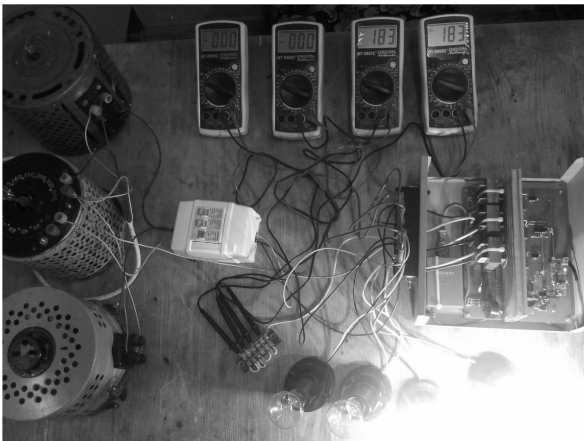
Сүрөт 9. 0,4 кВ БТ симметриялоочу орнотмо. СО менен СОсуз ченөөнүн тыянагы 10 сүрөттө көрсөтүлгөн.
