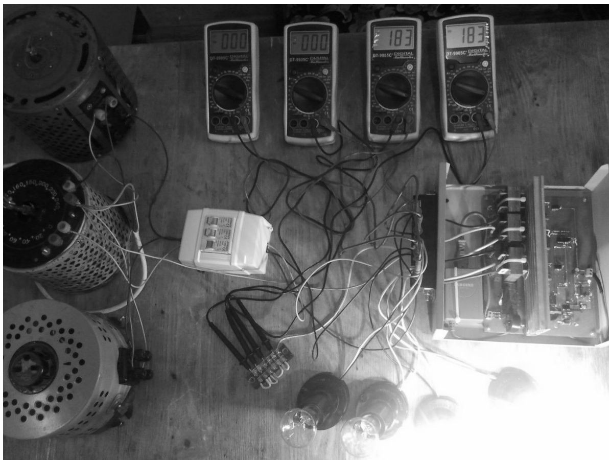
Рис. 9. Симметрирующее устройство в распределительных сетях 0,4 кВ
