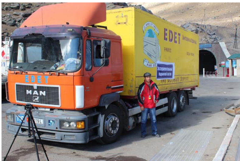
Рисунок 4 – Передвижная лаборатория на базе автомобиля MAN 26.403 Silent
