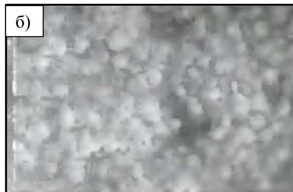
1-сүрөт. Структуранын электрондук сүрөттөрү: а) - «Тиниал» ОООсунда (Дүйшөмбү ш.) иштелип чыккан өндүрүш технологиясы боюнча даярдалган, жыштыгы 10 кг/м 3 болгон пенополистирол плитасы; б) – узак мөөнөттө пайдаланылган, жыштыгы 10 кг/м 3 болгон пенополистирол плитасы.
