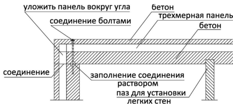
5-сүрөт. Заводдо даярдалган дубалдарды бириктирүү мүмкүнчүлүктөрү (Биринчи кабаттын дубалынын планы)
