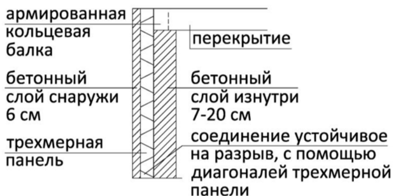
Рис.6. Конструкция трехмерной стены, изготовленной на заводе из легкого бетона (сечение)
