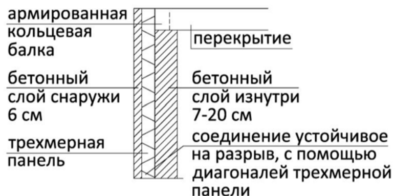
6-сүрөт. Заводдо жеңил бетондон жасалган, үчкырдуу дубалдын конструкциясы (жара кесилиши)
