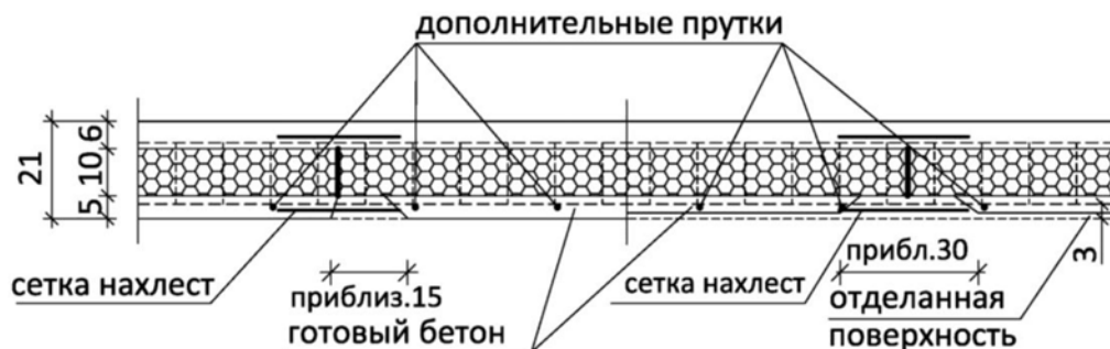
7-сүрөт. Заводдо астыңкы бетинин бир бөлүгү бетондолгон шып панелдер
