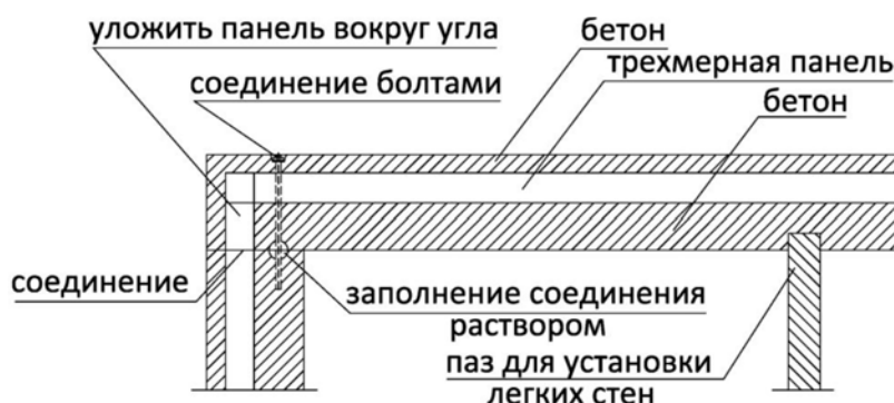
Рис.5. Возможности соединений для стен, изготовленных на заводе (План стены первого этажа)
