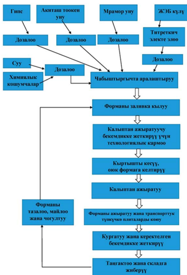
Сүрөт 11. Гипс оюк кырдуу плиталарды өндүрүү технологиялык схемасы
