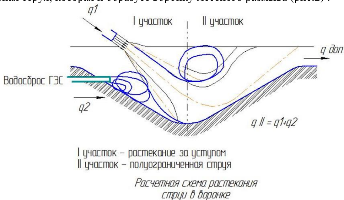
Рис. 2. Расчетная схема растекания струи в воронке.
