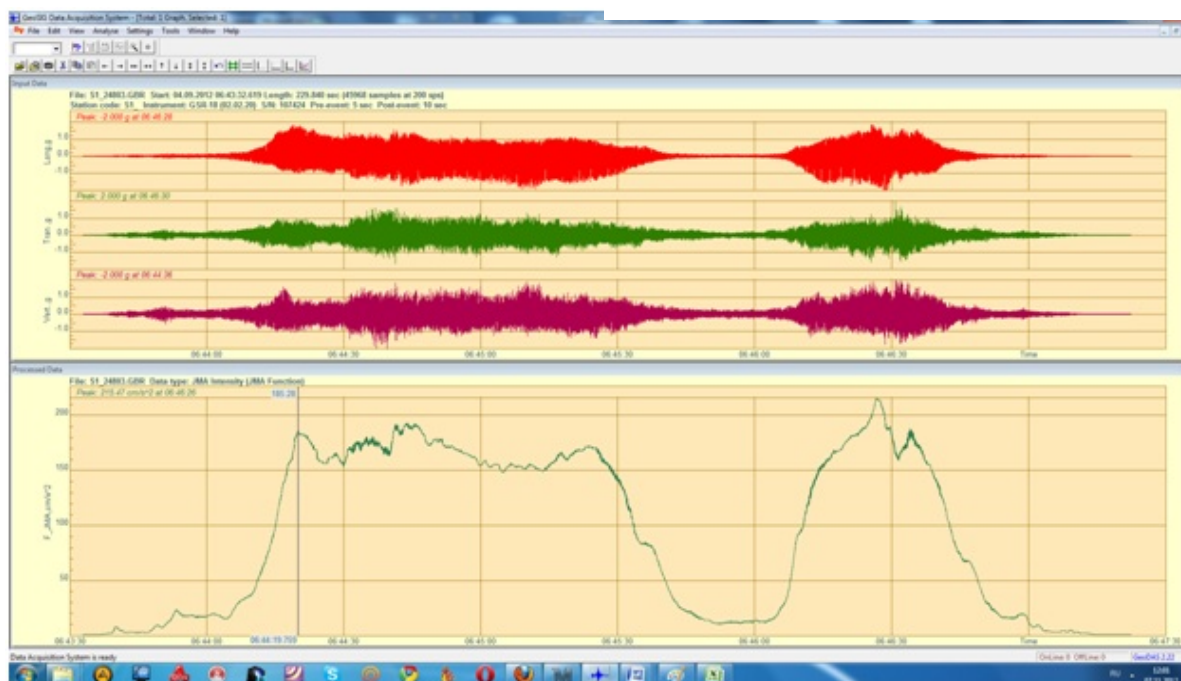
Рис.8. Запись интенсивности (балльности) колебаний виброплатформы модели дома «сокмо». Разрушение соответствует ускорению 185 см/с 2
