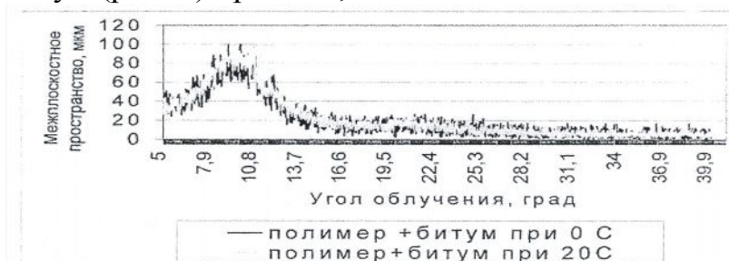
Рис. 2. Рентгенограмма для определения внутренних напряжений
