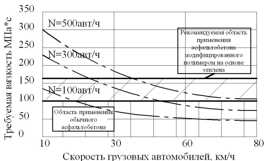
Рис. 5. Граница применения различных асфальтобетонных покрытий по критерию сдвигоустойчивости
