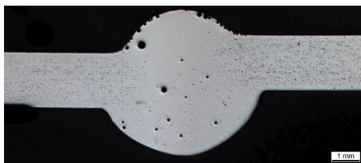
Рисунок 10 - Микрошлиф сварного шва, V = 3,5 м/мин
