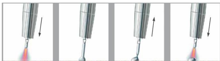
Рисунок 5 – Принцип работы СМТ дуги
