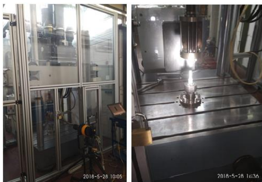
Рисунок 7 – Высокоскоростная испытательная машина «Amsler HTM 16020» на растяжение
