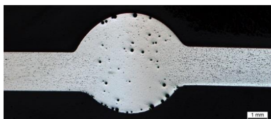
Рисунок 12- Микрошлиф сварного сварного шва, V = 5 м/мин
