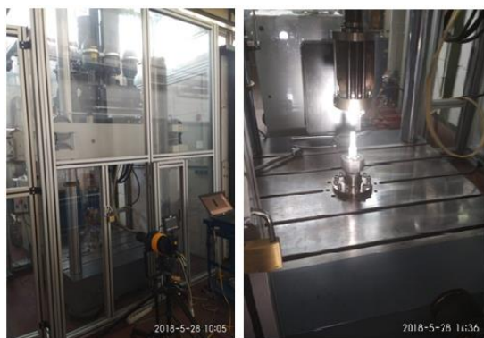
Рисунок 7 – Высокоскоростная испытательная машина «Amsler НТМ 16020» на пастяжение
