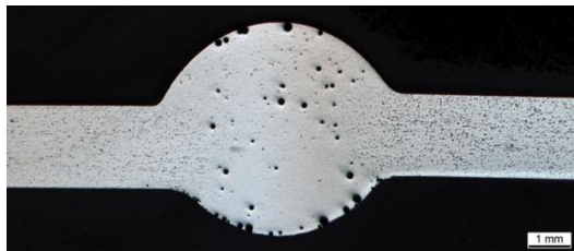
Рисунок 11 - Микрошлиф сварного шва, V = 4 м/мин
