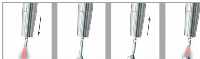
Рисунок 5 – Принцип работы СМТ дуги
