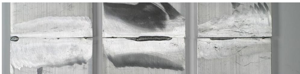
Рисунок 2. 9 – Обратная сторона сварного листа толщиной 6мм
