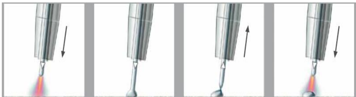
Рисунок 2. 2 – Принцип работы СМТ дуги
