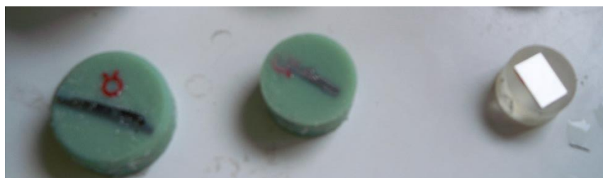
Рисунок 2. 17 –Готовые микрошлифы для обработки
