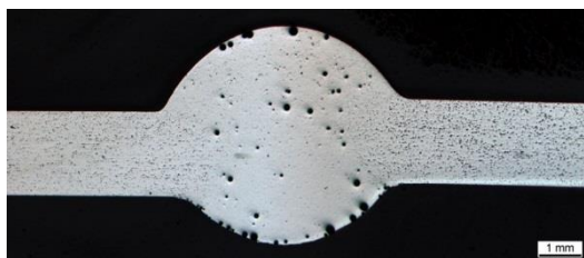
Рисунок 3.9 - Микрошлиф сварного шва, V = 5 м/мин
