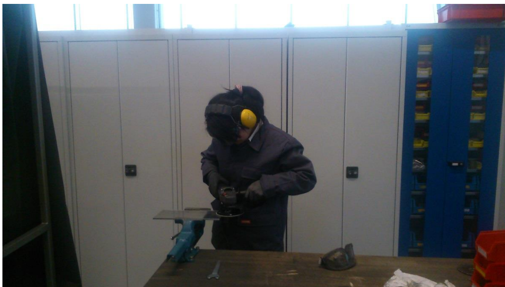
Рисунок 2. 4 – Зачистка листов для сварки.
