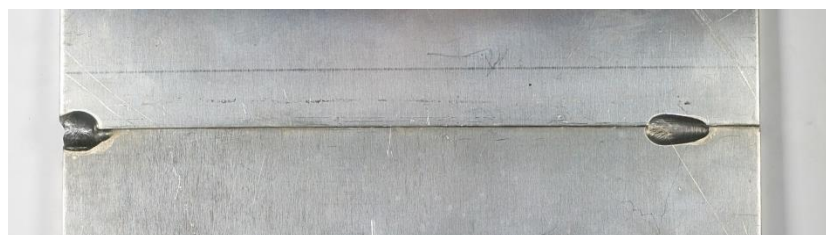
Рисунок 2. 7 – Обратная сторона сварного листа толщиной 2мм
