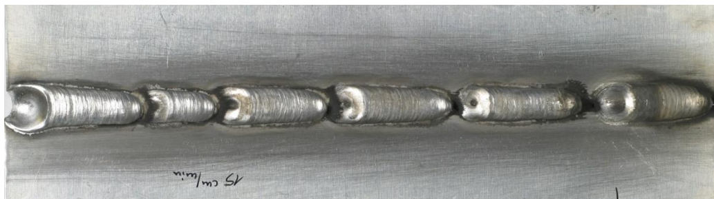
Рисунок 2. 6 – Лицевая сторона сварного листа толщиной 2мм
