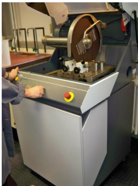
Рисунок 2. 14 –Установка для резки металла для микрошлифа
