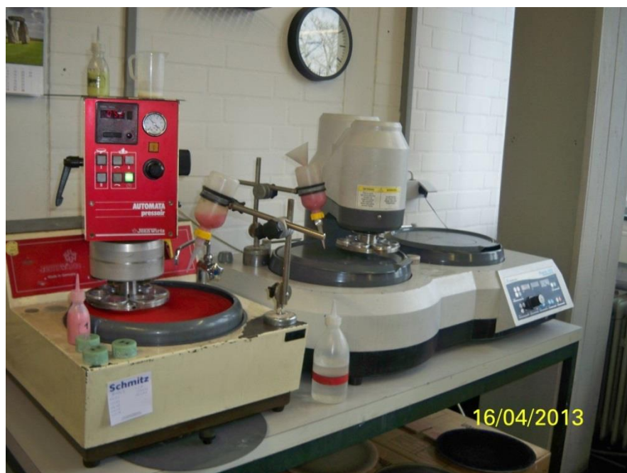
Рисунок 2. 19 – установка для полирования микрошлифов
