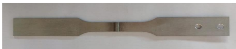
Рисунок 2. 11 – Образец, подготовленный для испытания на растяжение
