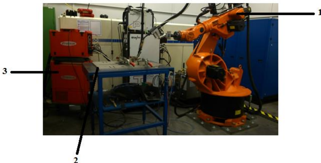
Рисунок 2. 1 – Сварочное оборудование СМТ,1-сварочный робот «Кукa»,2-сварочный стол,3-сварочная установка
