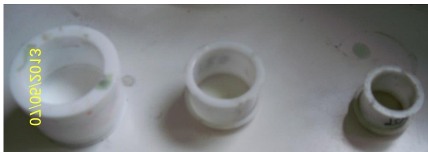
Рисунок - 2.16 Формы для микрошлифов
