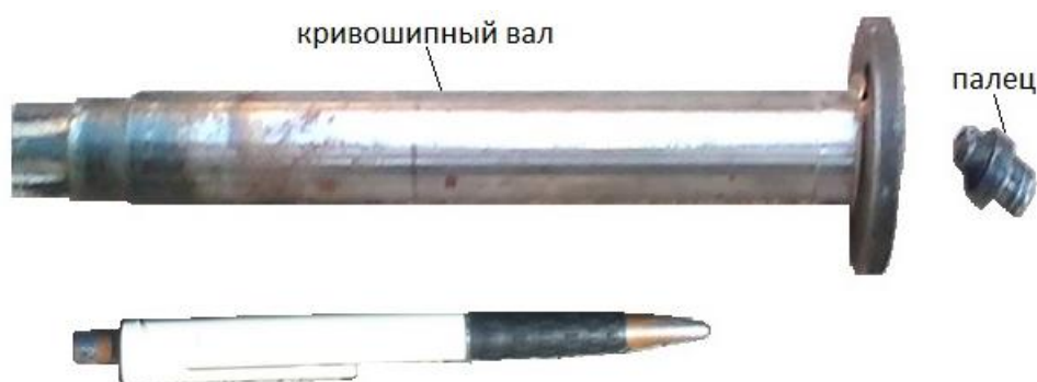
Рисунок 4.29 - Поломка кривошипного вала опытного образца перфоратора
