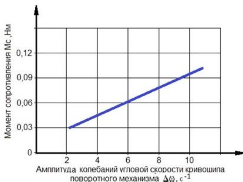
Рисунок 3.18–Зависимость амплитуды колебаний угловой скорости кривошипа поворотного механизма от величины момента сопротивления
