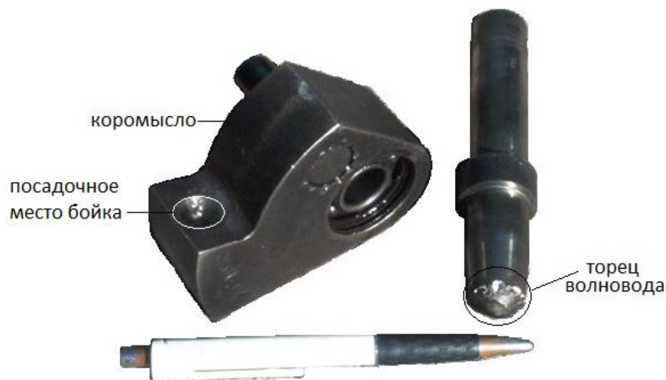
Рисунок 4.28 - Поломки коромысла и волновода опытного образца перфоратора
