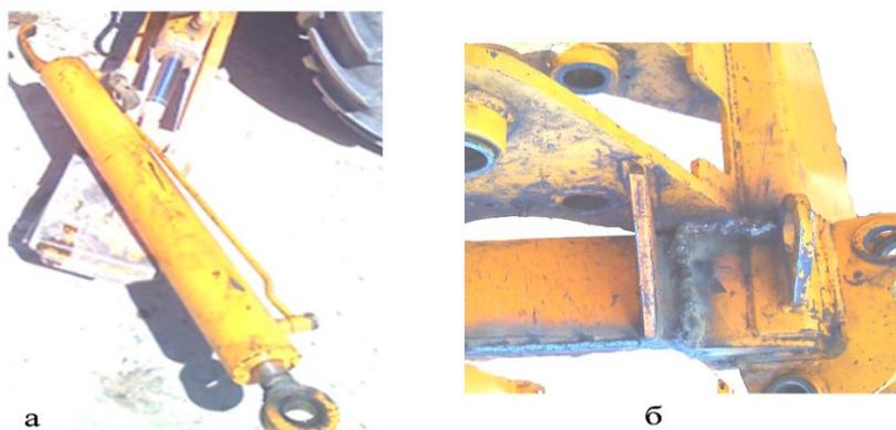
Рисунок 4 – Разрушение ушек гидроцилиндров (а) и оголовки стрелы (б)
