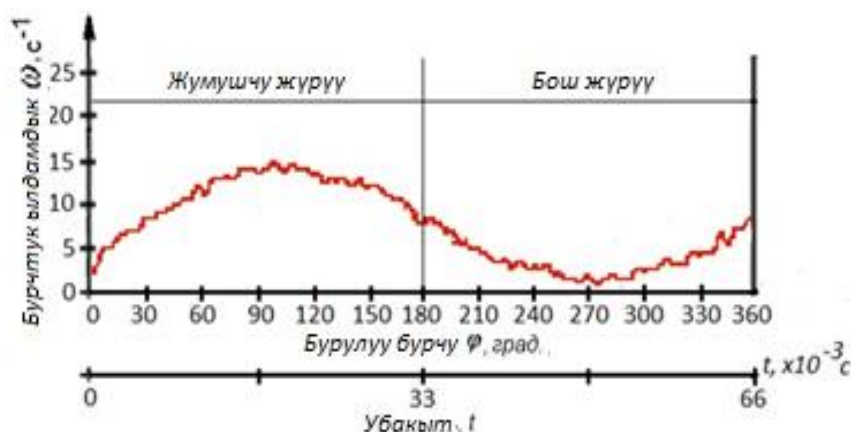
11 - сүрөт. Аспаптын бурчтук ылдамдыгынын маанисинин эксперименталдык диаграммасы
