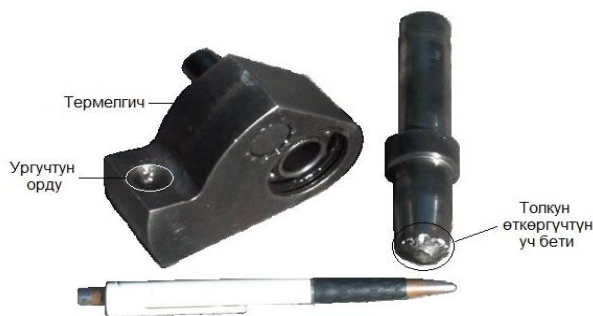
12 - сүрөт. Перфоратордун термелгичинин жана толкун өткөргүчүнүн сынышы
