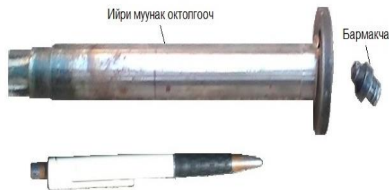
13 - сүрөт. Перфоратордун ийри муунак октолгоочунун сынышы
