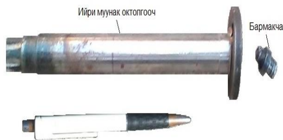
13 - сүрөт. Перфоратордун ийри муунак октолгоочунун сынышы
