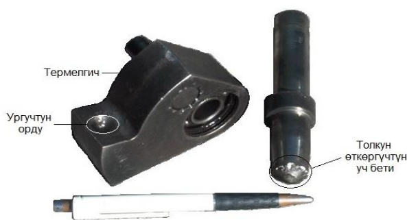
12 - сүрөт. Перфоратордун термелгичинин жана толкун өткөргүчүнүн сынышы
