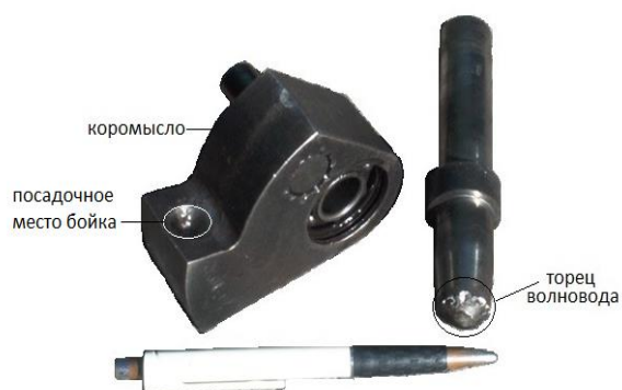
Рисунок 12 - Поломки коромысла и волновода опытного образца перфоратора
