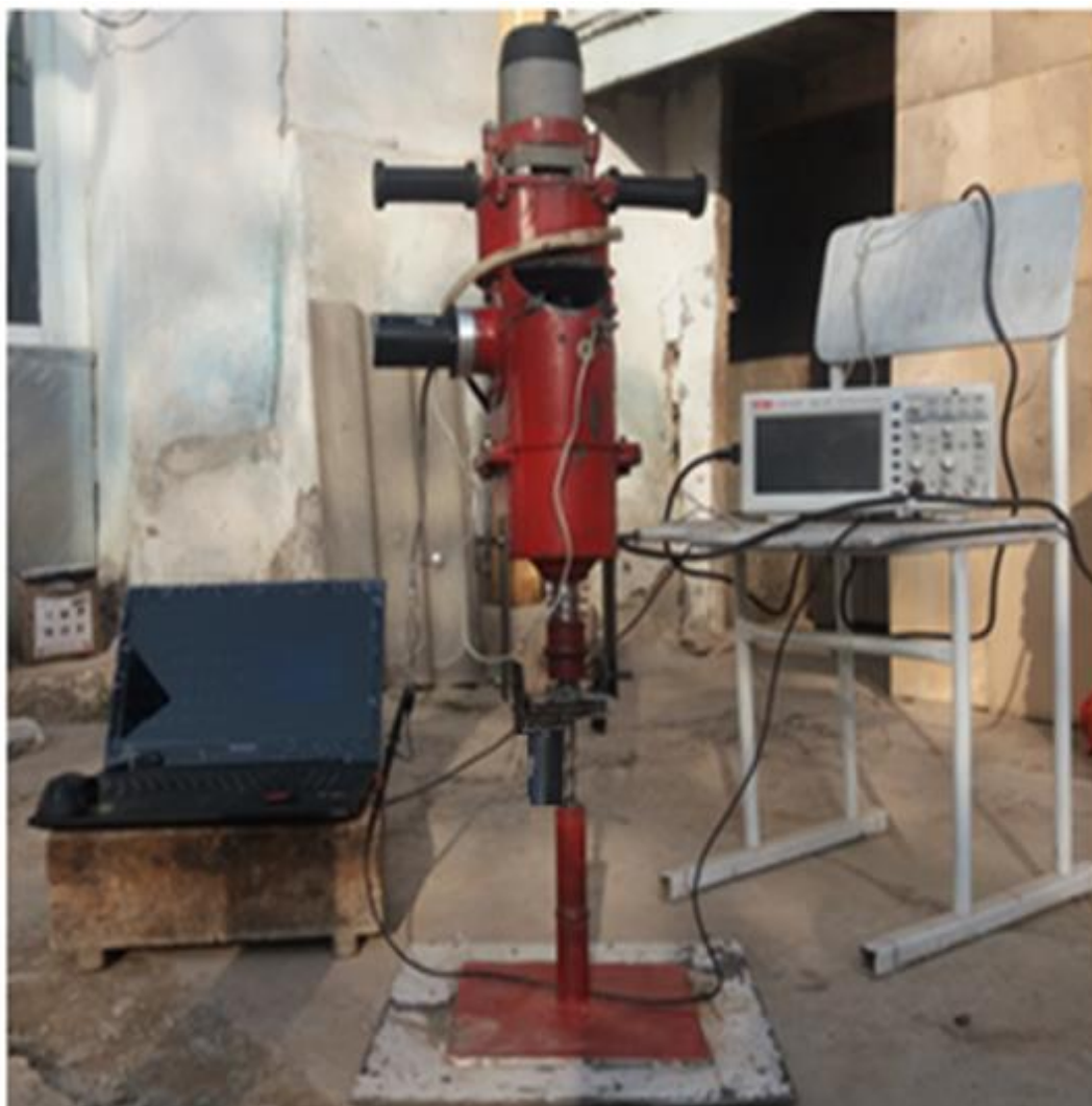
Рисунок 4.19 - Экспериментальный стенд для исследования динамики электромеханического перфоратора
