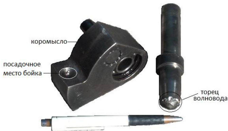
Рисунок 4.28 - Поломки коромысла и волновода опытного образца перфоратора
