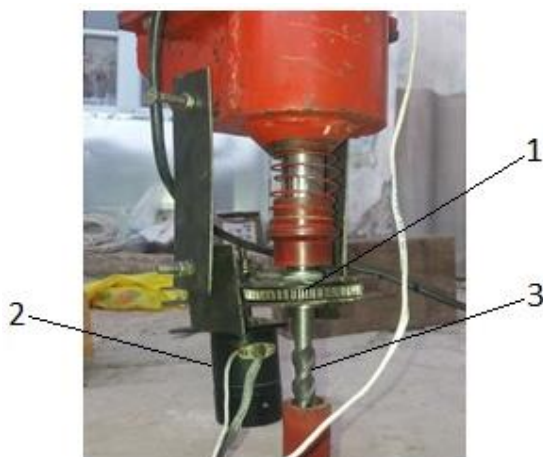
Рисунок 4.24 - Общий вид крепления генератора постоянного тока и инструмента перфоратора
