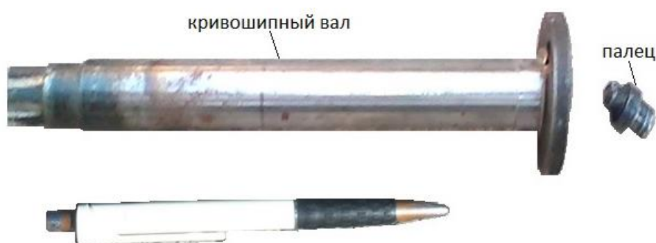
Рисунок 4.29 - Поломка кривошипного вала опытного образца перфоратора
