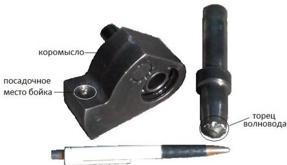
Рисунок 4.28 - Поломки коромысла и волновода опытного образца перфоратора
