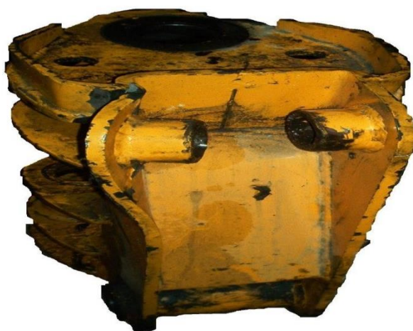
Рисунок 1.2.5. Разрушение опоры стрелы
