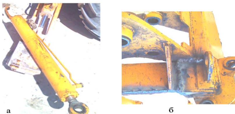
Сүрөт 4 – гидравликалык цилиндрлердин (а) кулактарынын жана жебенин (б) башынын бузулушу
