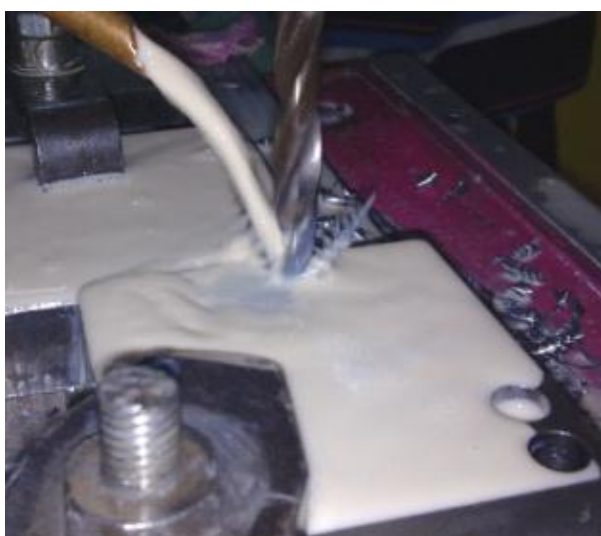
Рисунок 2.2 – Установка обрабатываемой заготовки на столе станка
