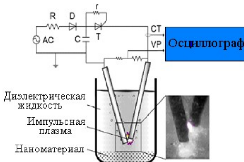
Рисунок 2.3.2 – (б) Электрическая схема для диспергирования металлов в ИПЖ.
