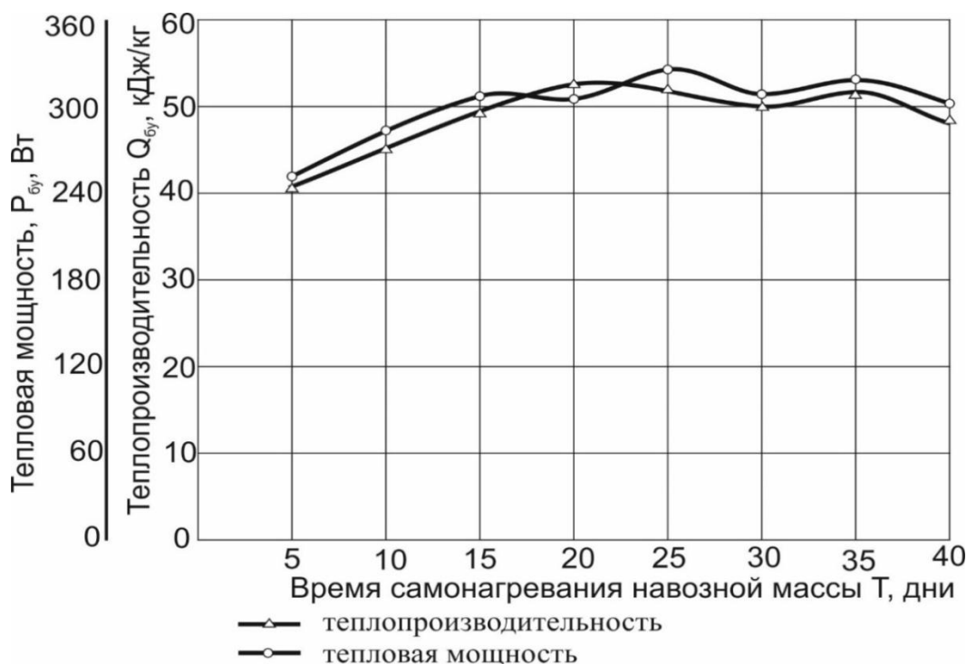
Рисунок 3.20 – Зависимость теплопроизводительности и тепловой мощности биотермической установки от времени самонагревания навозной массы
