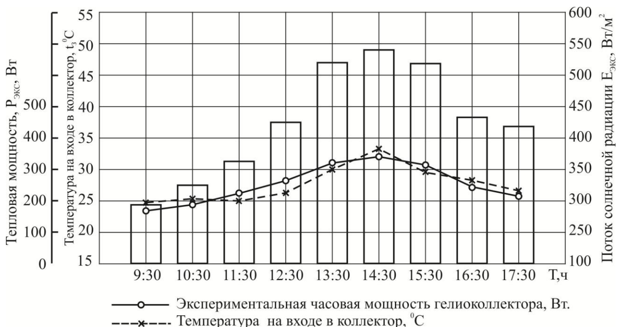
Рисунок 3.4 – Зависимость температуры на входе в коллектор [ t_3=f(T) ] и потока солнечной радиации [ E_{экс}=f(T) ] от времени нагрева T
