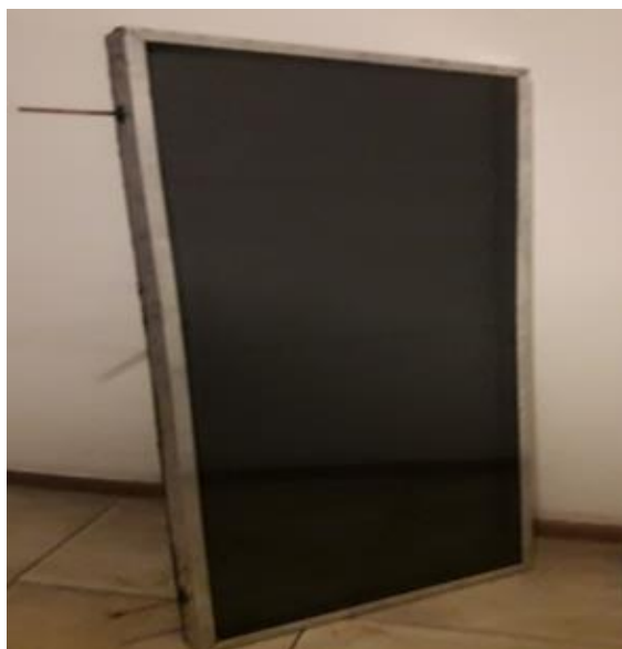
3-сүрөт – Жалпак күн коллекторунун макети
