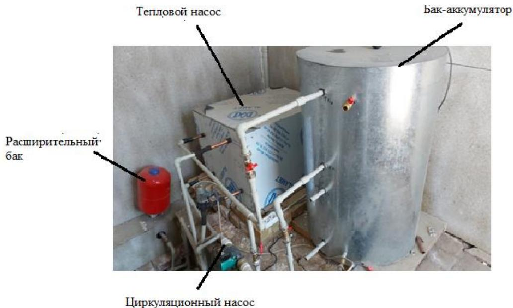
Рисунок 5 – Экспериментальный образец и общий вид двухконтурной гелиоустановки
