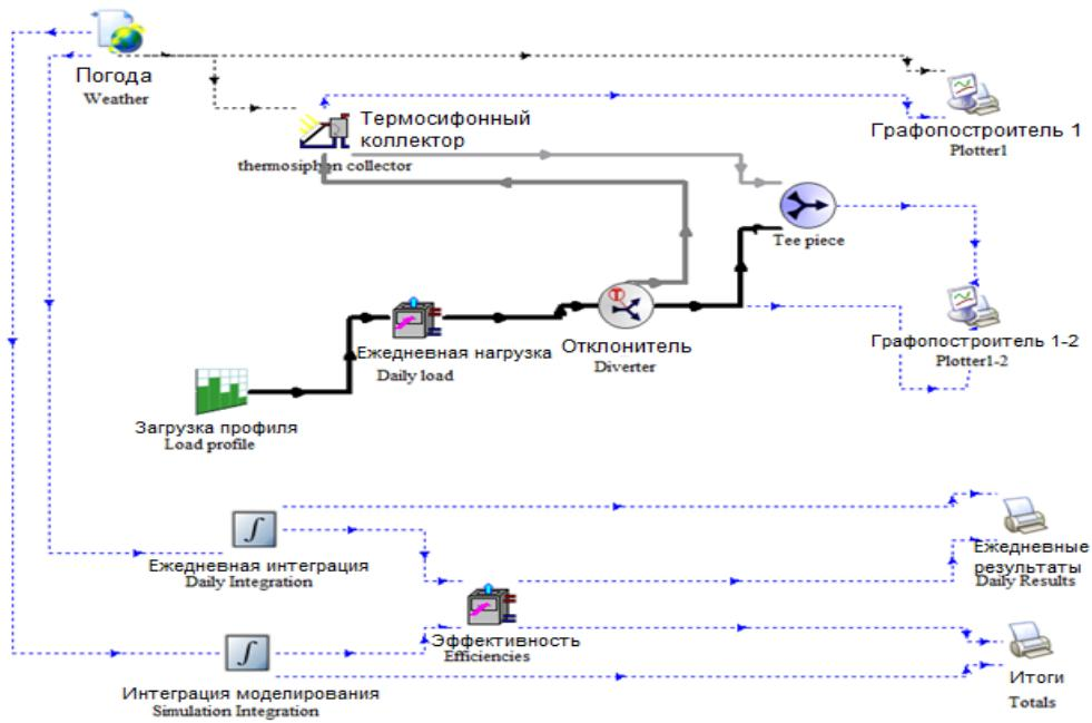
Рисунок 9 – Схема TRNSYS моделируемой термосифонной системы солнечного коллектора
