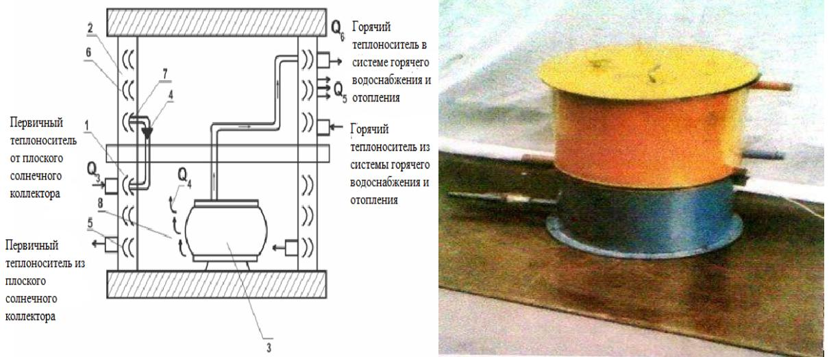
Рисунок 4 – Схема нового технического решения теплового насоса в разрезе
