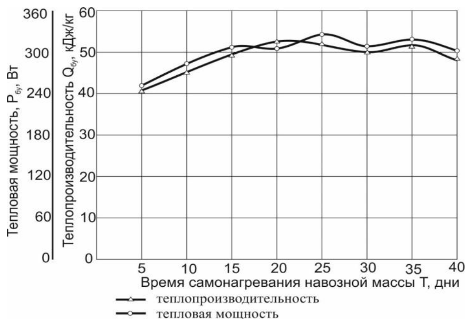
Рисунок 11—Зависимость теплопроизводительности и тепловой мощности биотермической установки от времени самонагревания навозной массы
