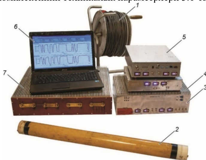
5.1 Сүрөт. ЭЧК ЧСС өлчөө комплексинин эксперименталдык үлгүсү, сырткы көрүнүшү: 1 – индукциялык зонд рамкасы (ИЗД); 2 – индуктивдүү сигналдын датчиги (ИСД); 3 – зонд сигналынын генератору (ЗСГ); 4 – градуировкалоочу түзүлүш (ГТ); 5 – башкаруу-сигнал жазуу блогу (БСЖБ); 6 – ноутбук компьютер (НК); 7 - токту чектөө блогу (ТЧБ) (автор тарабынан аткарылган)
