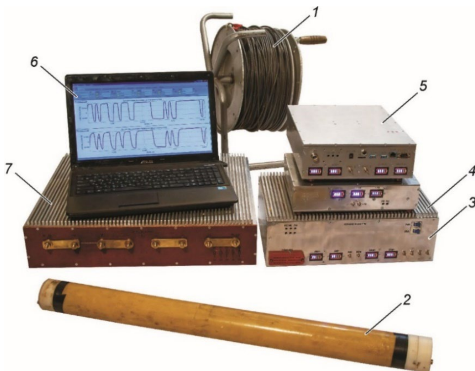
Рис. 5.1. Экспериментальный образец измерительного комплекса ЭРК ШПС, внешний вид: 1 – индукционная зондирующая рамка (ИЗР); 2 – индукционный датчик сигналов (ИДС); 3 – генератор зондирующих сигналов (ГЗС); 4 – устройство градуировки (УГ); 5 – блок управления и регистрации сигналов (БУРС); 6 – переносной компьютер (ПК); 7 – блок ограничения тока (БОТ) (выполнено автором)
